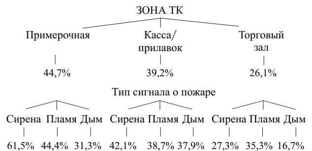
РИС. 3. Процент выполнивших инструкцию о действиях при пожаре служащих в зависимости от типа сигнала о пожаре в различных зонах ТК
